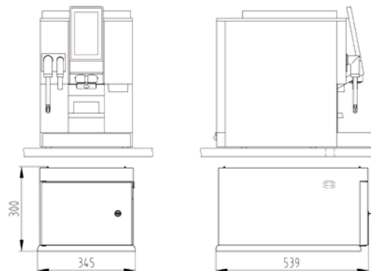
Unterstellkühlleinheit unter Kaffeemaschine
